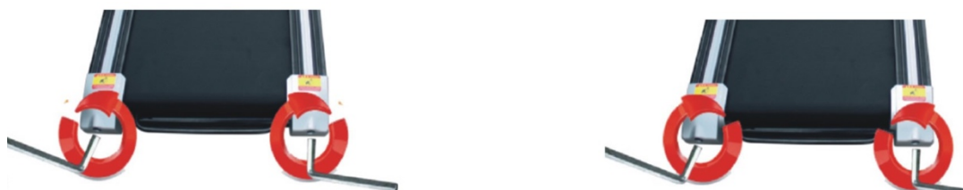
Рисунок А. Регулировка ленты, смещающейся вправо
